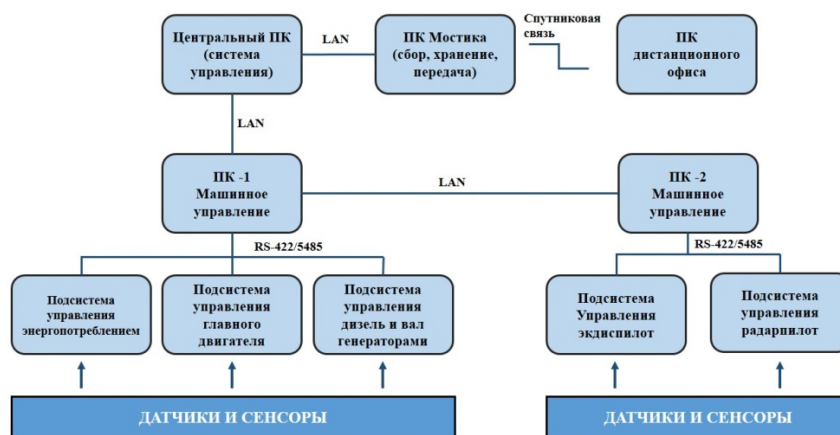
Рисунок 5. Архитектура системы NACOS MCS PLATINUM
