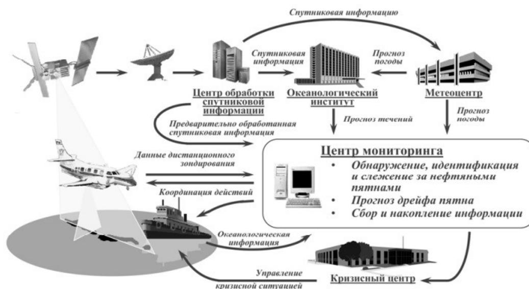
Рис. 1. Схема обнаружения и контроля нефтесодержащих вод без искусственного интеллекта
