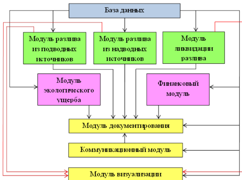
Рис. 7. Схема взаимодействия модулей программно-аппаратного комплекса «PISCES 2-CMS»
