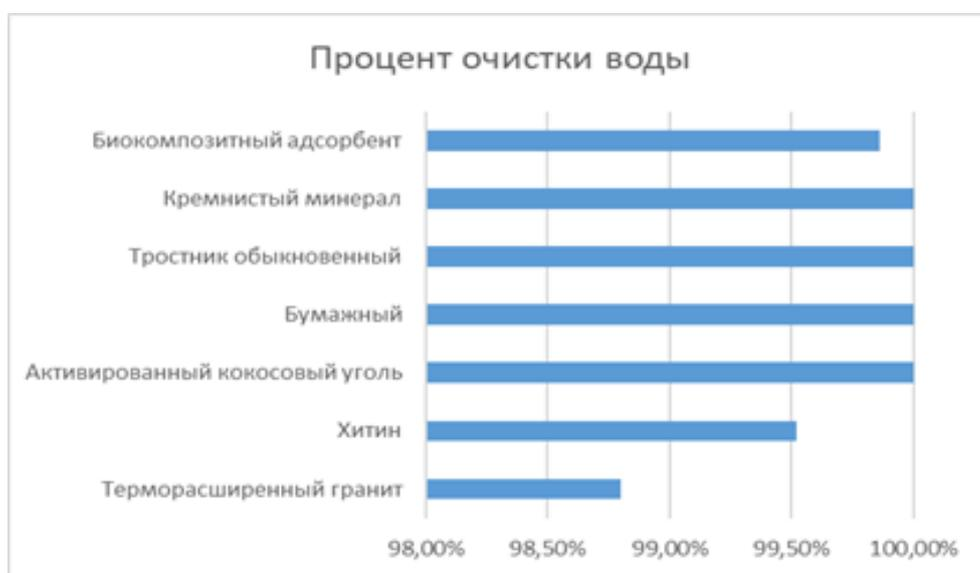
Рис. 2. Сравнительная диаграмма процента очистки воды различными типами сорбентов
