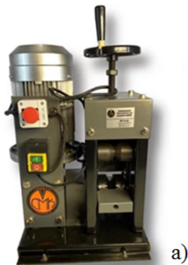
Рис. 4. Станок для разборки бронированного кабеля диаметром от 2 до 80 мм методом разрезания: а) общий вид станка, б) кинематическая схема: 1 – мотор редуктор; 2 – муфта; 3,4 – жилы и оплетка кабеля; 5 – ролики; 6 – нож [6]
