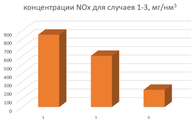
Рис. 2а. Образование оксидов азота в топке котла ТГМП-114 на номинальной нагрузке при различных режимах сжигания мазута для для вышеперечисленных случаев горелок с обычной и усовершенствованной конструкцией
