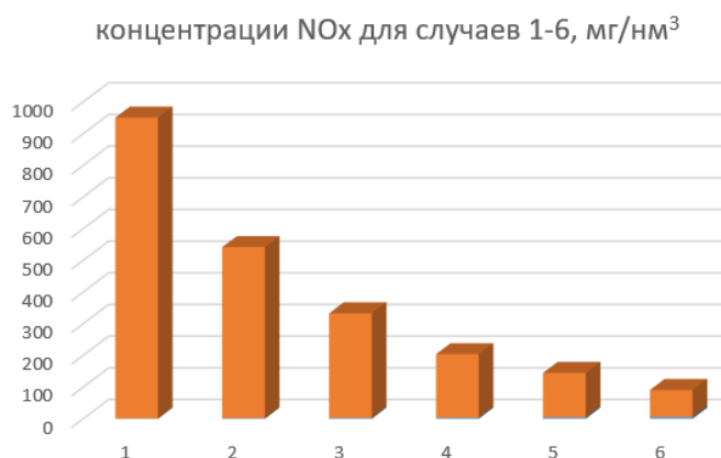
Рис. 2. Образование оксидов азота в топке котла ТГМП-114 на номинальной нагрузке при различных режимах сжигания газа и мазута для следующих случаев горелок с обычной и усовершенствованной конструкцией: 1) вихревые горелки обычной конструкции (УП НА ДРГ = 0. \alpha_{III}=0 ); 2) вихревые горелки обычной конструкции (УП НА ДРГ = 100. \alpha_{III}=0 ); 3)*низкотоксичные горелки (УП НА ДРГ = 0. \alpha_{III}=0 ) на газе, (УП НА ДРГ = 100. \alpha_{III}=0 ) на мазуте; 4) низкотоксичные горелки (УП НА ДРГ = 0. \alpha_{III}=20\% ); 5)*низкотоксичные горелки (УП НА ДРГ = 100. \alpha_{III}=0\% ); 6)низкотоксичные горелки (УП НА ДРГ = 100. \alpha_{III}=20\% )
